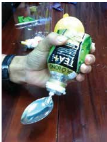
Dụng cụ: thìa với cán làm bằng vỏ chai nước. Mục đích: làm tay cầm thật dày để dễ cầm nắm thìa
