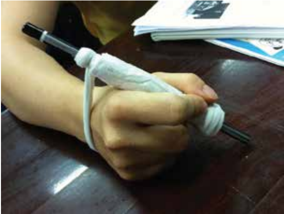
Dụng cụ: bút viết có tay cầm bằng vải Mục đích: để cho trẻ có thể cầm chặt bút khi vẽ
